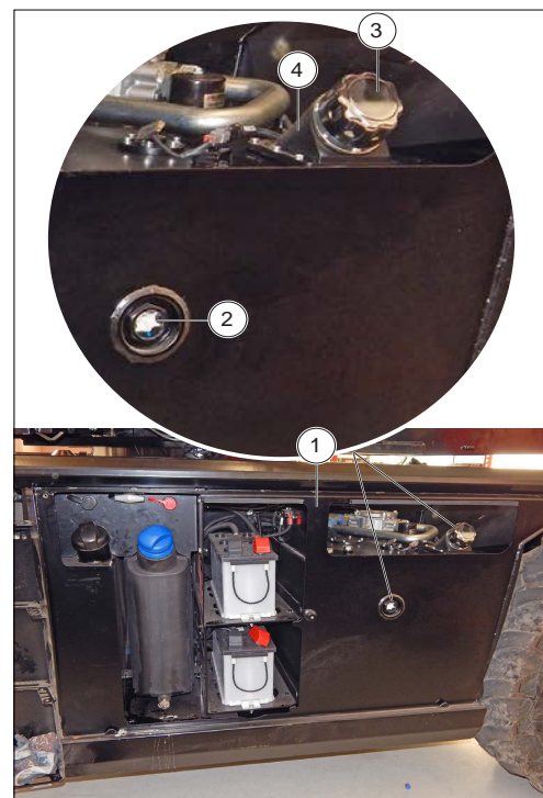
Figure 153: Vérification du niveau d'huile hydraulique
